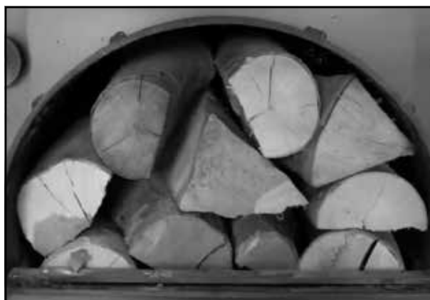
Die richtig befüllte Kammer im Detail
