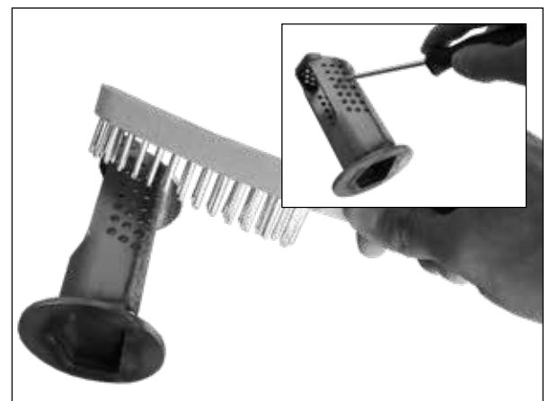
Die Reinigung des Zündkammer
