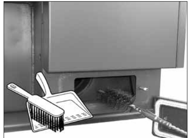
Vorführung der Reinigung des Rauchkanals mit Drahtbürste.
